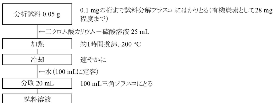
図1 汚泥肥料、堆肥等中の有機炭素試験法フローシート(二クロム酸酸化操作)
