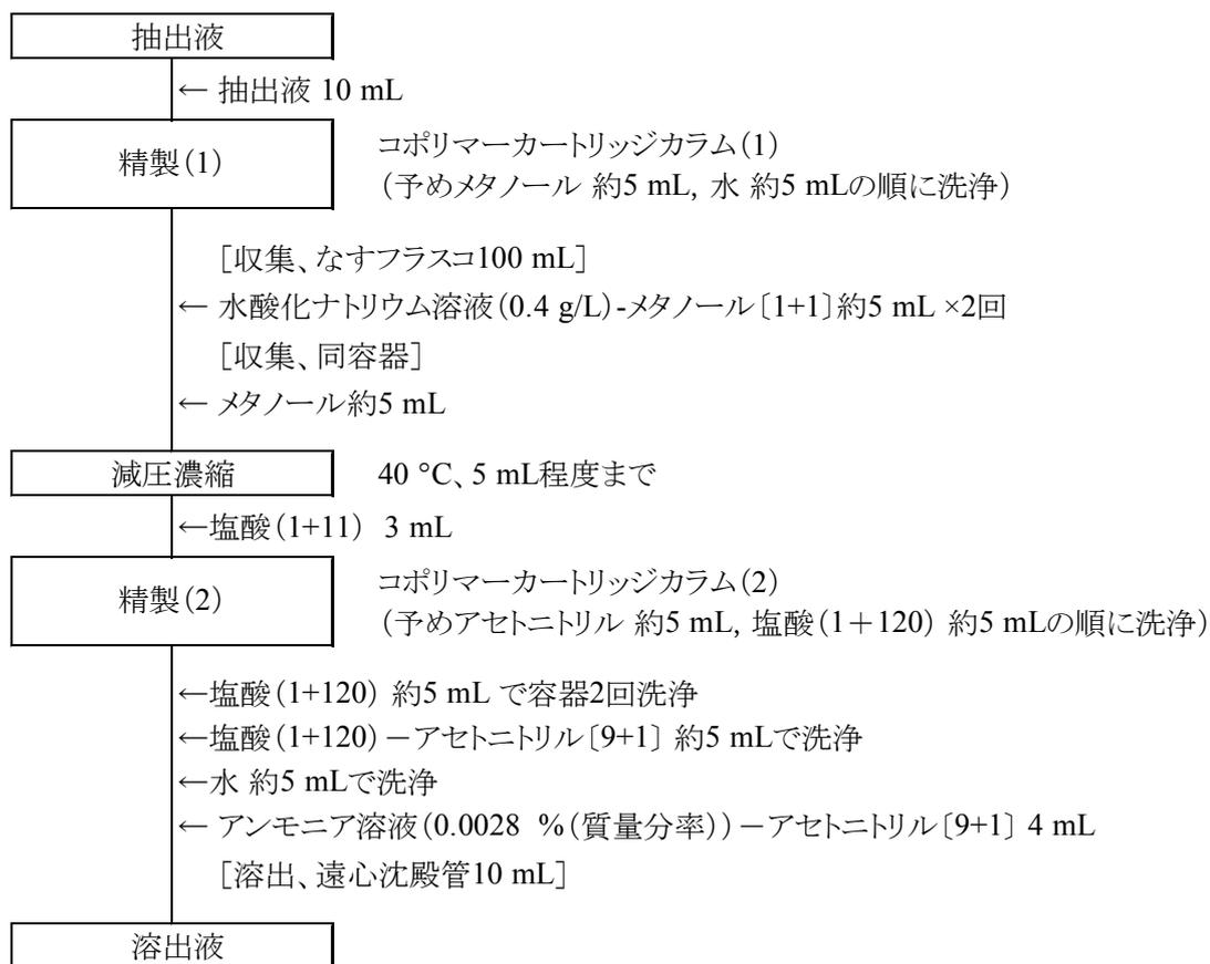
図2 堆肥及び汚泥発酵肥料中のクロピラリド試験法フローシート
