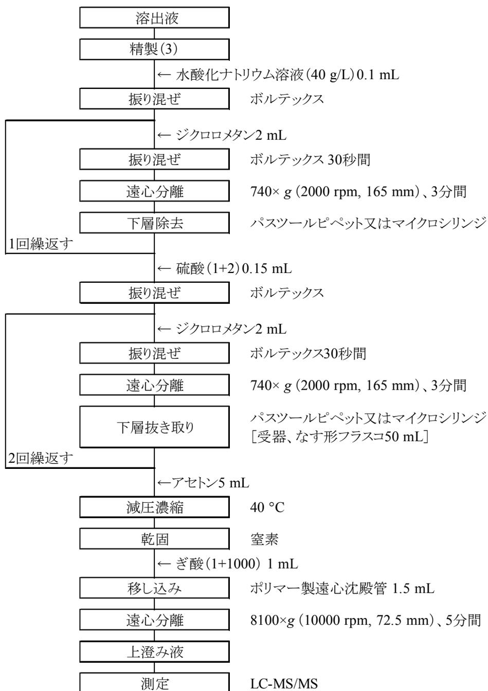
図2 堆肥及び汚泥発酵肥料中のクロピラリド試験法フローシート
