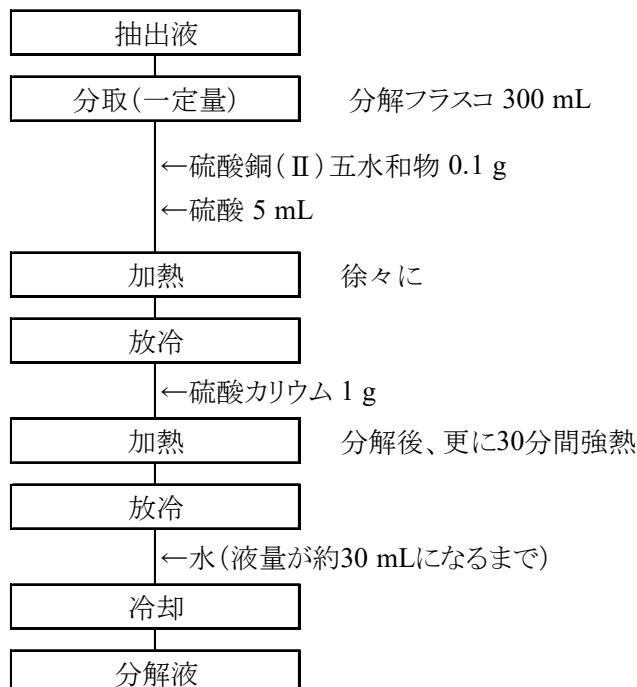
図2 ホルムアルデヒド加工尿素肥料中の冷緩衝液可溶性窒素試験法フローシート
