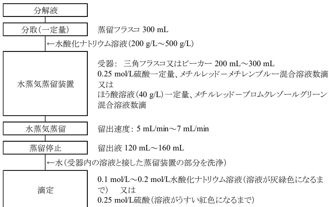
図3 メチロール尿素重合肥料中の熱緩衝液可溶性窒素試験法フローシート
