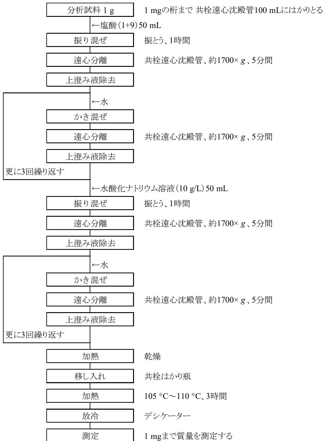
図2 腐植酸塩肥料中の腐植酸試験法フローシート
