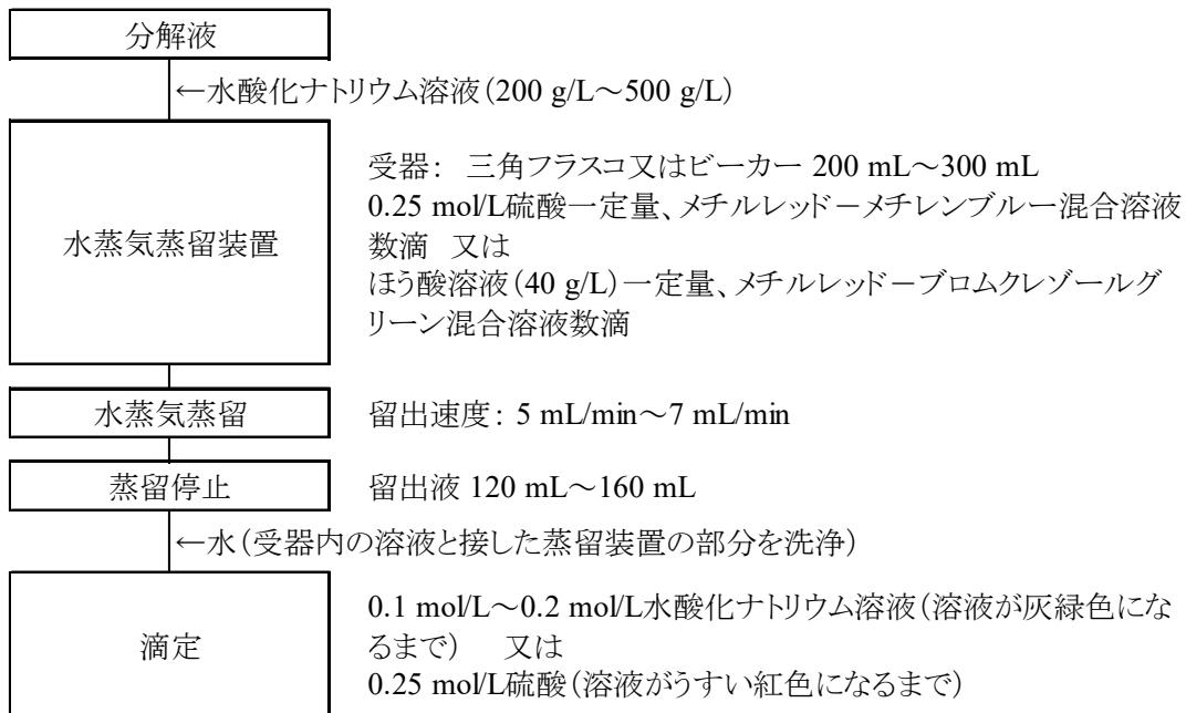
図3 ホルムアルデヒド加工尿素肥料中の冷緩衝液可溶性窒素試験法フローシート
