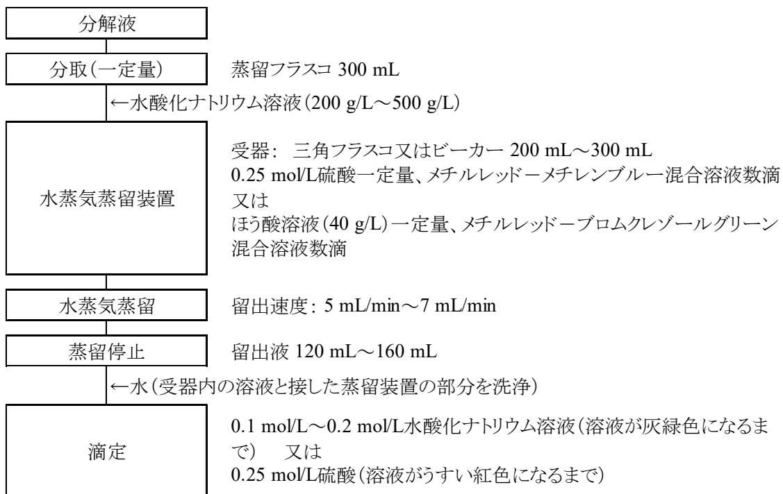
図3 ホルムアルデヒド加工尿素肥料の窒素の活性係数試験法フローシート
