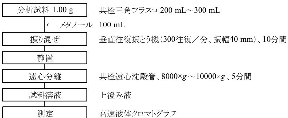
図 石灰窒素及び石灰窒素を含有する肥料中のジシアンジアミド性窒素試験法フローシート
