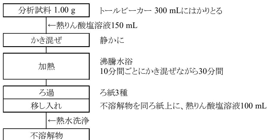
図1 メチロール尿素重合肥料中の熱緩衝液可溶性窒素試験法フローシート
