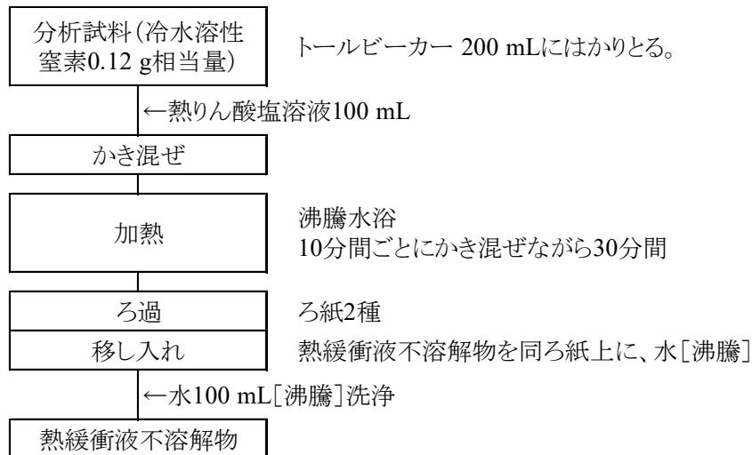
図1-2 ホルムアルデヒド加工尿素肥料の窒素の活性係数試験法フローシート
