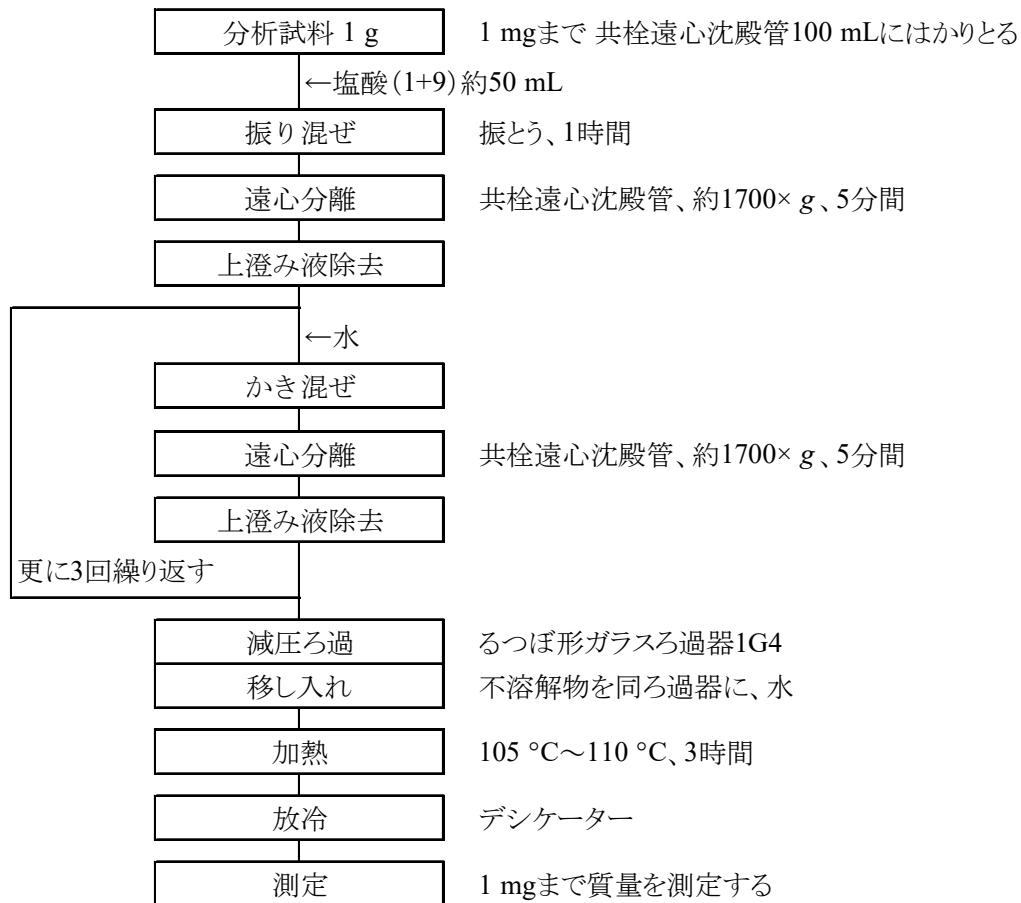
図1 腐植酸塩肥料中の腐植酸試験法フローシート
