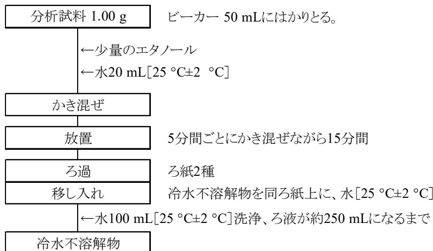
図1-1 ホルムアルデヒド加工尿素肥料の窒素の活性係数試験法フローシート
